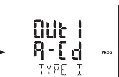
SEUIL HAUT DE LA SORTIE RELAIS N° 1 - Exemple : Ht = 100 kA
